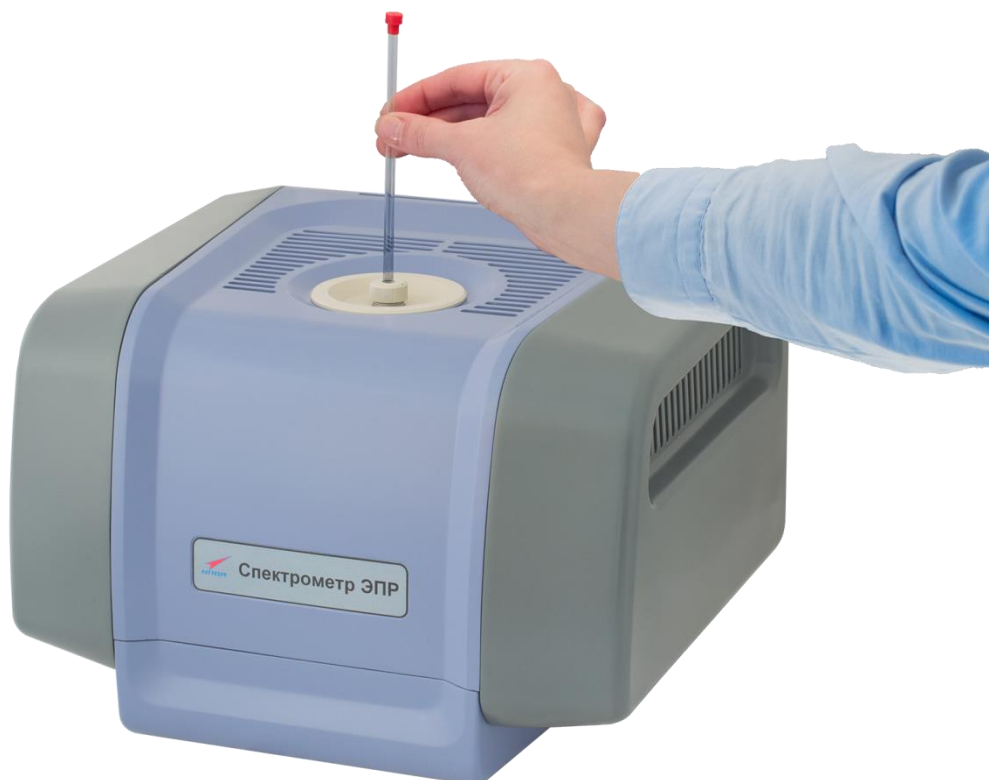
Рис. 3. ЭПР спектрометр Labrador study
